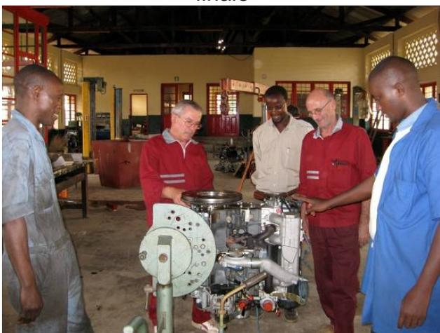
Un diesel Fiat montato su un supporto rotante
